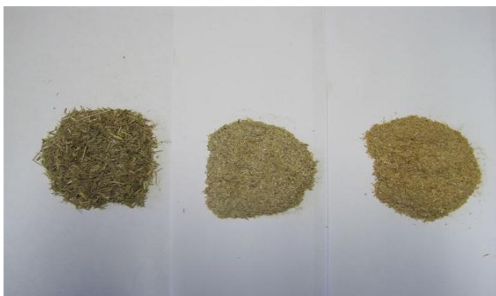
Fig. 2. Residuos arroceros después de pretratamiento físico: paja de arroz (izquierda), residuo del proceso de secado (centro), cáscara de arroz (derecha).
